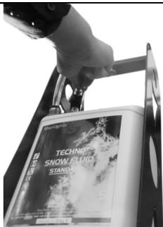
Una volta azionato il macchinario aprire la valvola di regolazione del flusso per erogare la neve
