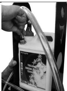
Collegare la tubazione flessibile che immette il liquido nel tubo eiettore dal serbatoio. In particolare la tubazione grande per l'immissione i aria e la piccola per l'aspirazione del liquido
